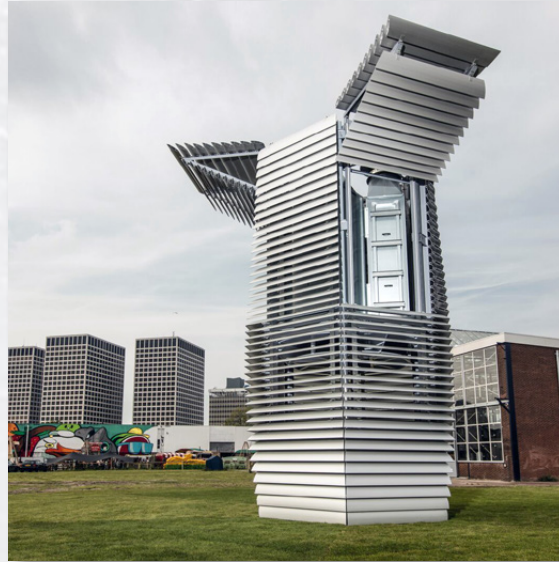
Deze toren zuigt fijnstofdeeltjes op en filtert de lucht.
